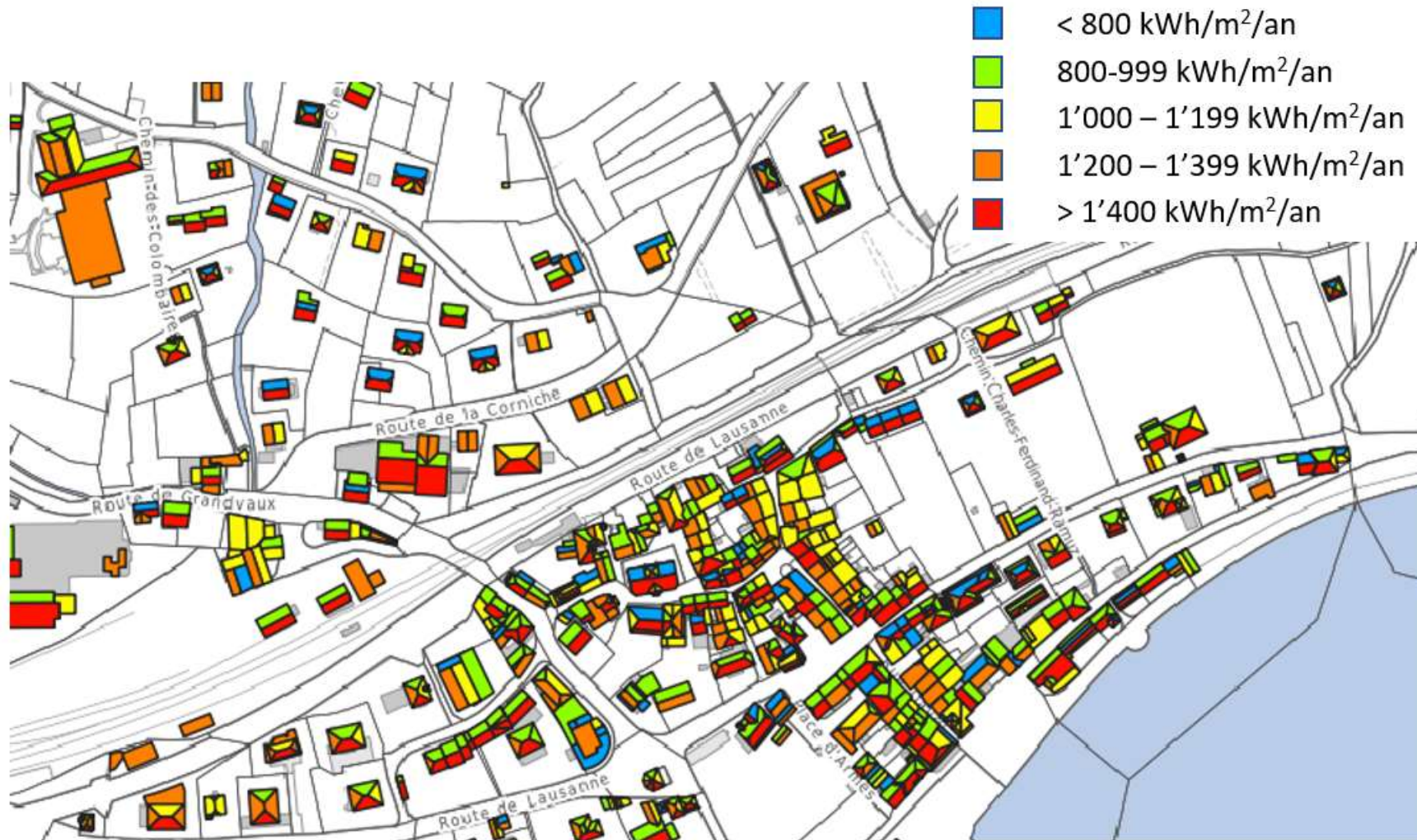
Figure 23 : Exemple du rayonnement solaire sur Cully [MWh/m 2 /an] [27]
