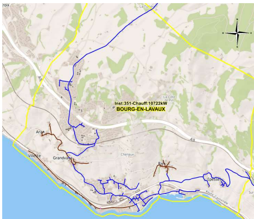
Figure 14 : Réseau de gaz [17] Différence (bleu : conduites haute pression, brun : conduites basse pression)
