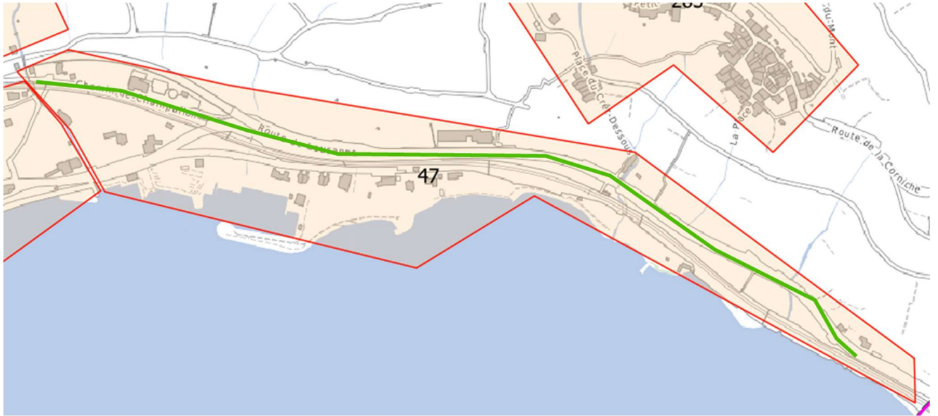
Figure 60 : Tracé approximatif d'un éventuel réseau thermique (en vert, longueur : ~ 1'400 m), secteur du Bord de Lac Est
