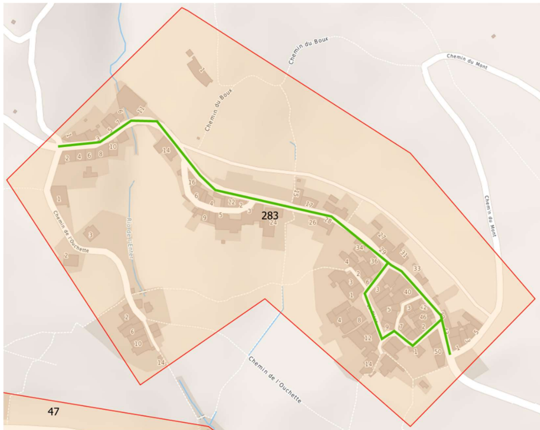
Figure 53 : Tracé approximatif d'un éventuel réseau thermique (en vert, longueur : ~ 630 m), secteur du Bourg d'Espes
